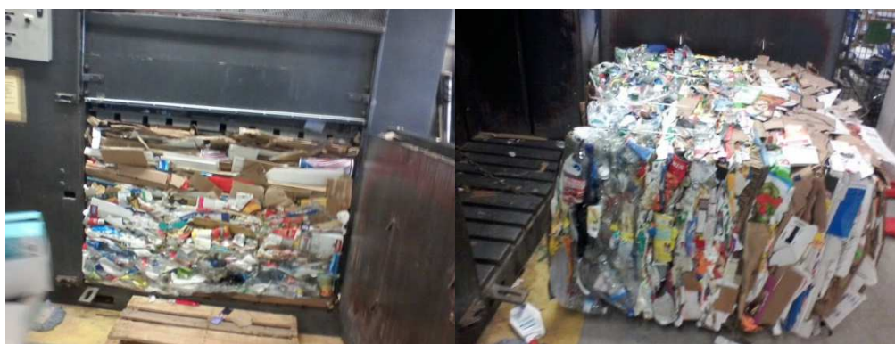
Photographie 4 : Presse à carton et ballot de matières résiduelles recyclables
