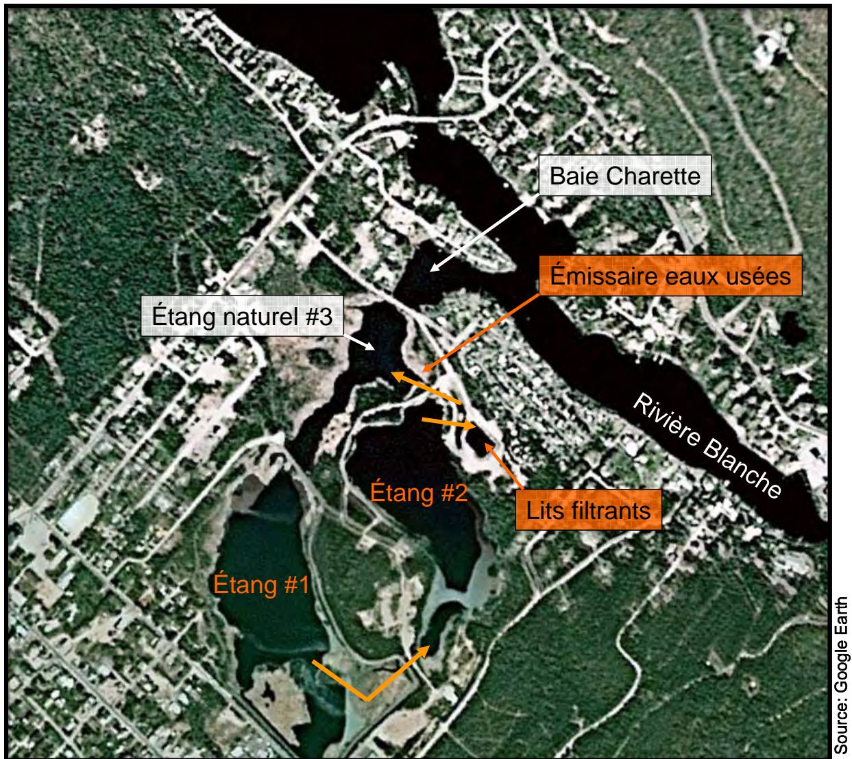
FIGURE 2. LOCALISATION DES DIFFÉRENTS ÉTANGS (LES FLÈCHES JAUNES INDIQUENT LE SENS DE LA CIRCULATION DES EAUX USÉES)
