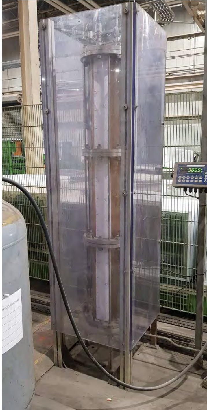
Figure 1 Colonne de séparation
