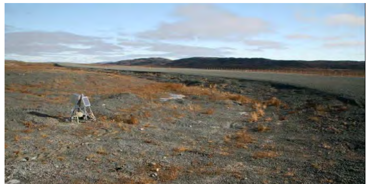
Station de suivi thermique du pergélisol en bordure de piste d'atterrissage. Tiré de Allard et al. 2017, Figure 37.
