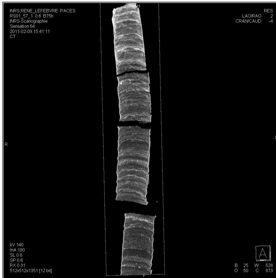
Figure 2.22 : Exemple de scannographie d'un échantillon de sol prélevé lors du forage RS01
