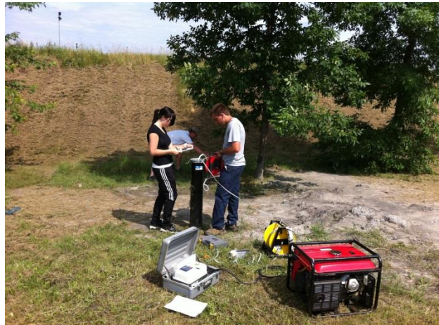
Réalisation des essais de pompage à grand débit (à gauche) et à faible débit (à droite)
