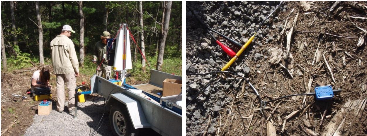
Réalisation des relevés de sismique-réfraction
