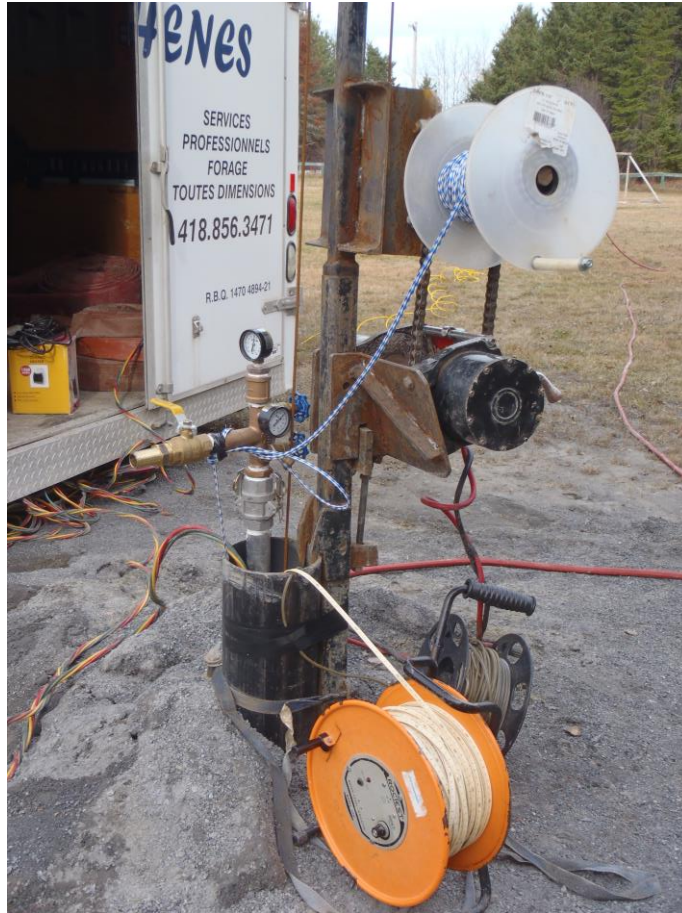
Figure 3.10 : Réalisation d'un essai de pompage dans le puits de Saint-Eugène-de-Ladrière en novembre 2013.
