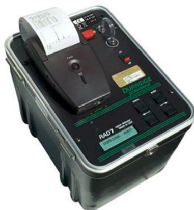
Figure 7.16 : Instrument RAD7 utilisé pour les mesures in situ du ^{222}\text{Rn}
