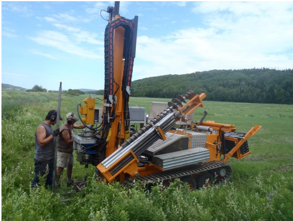
Figure 3.4. Sondage stratigraphique effectué en 2013 à Saint-Simon avec la foreuse géotechnique de l'INRS-ETE.
