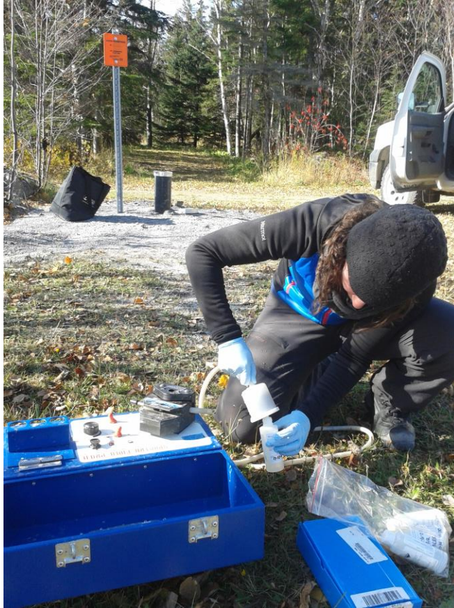
Figure 3.7 : Utilisation d'un filtre Watterra haute capacité lors de l'échantillonnage d'eau du puits du réseau de suivi des eaux souterraines à Notre-Dame-des-Neiges.
